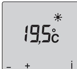
Drücken Sie die Tasten + oder – um den gewünschten Wert einzugeben und drehen Sie anschließend den Regler, um den Vorgang zu beenden.
